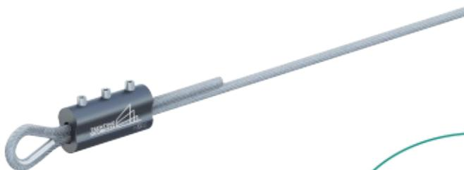
3] Avvitare per prima la vite centrale, poi in sequenza le altre due con coppia di serraggio di 20 Nm (serraggio forte)
